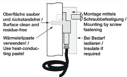
Die Oberfläche muss blank poliert und frei von Rückständen sein. Bringen Sie den Fühler bitte fest an. Achten Sie bitte auf einen guten thermischen Kontakt, verwenden Sie ggf. Wärmeleitpaste. Je nach Anforderung kann es sinnvoll sein, den Fühler zu isolieren um den Einfluß der Umgebungstemperatur zu minimieren.
