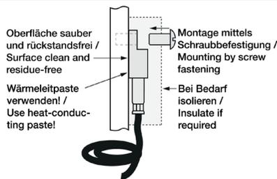
Die Oberfläche muss blank poliert und frei von Rückständen sein. Bringen Sie den Fühler bitte fest an. Achten Sie bitte auf einen guten thermischen Kontakt, verwenden Sie ggf. Wärmeleitpaste. Je nach Anforderung kann es sinnvoll sein, den Fühler zu isolieren um den Einfluß der Umgebungstemperatur zu minimieren.
