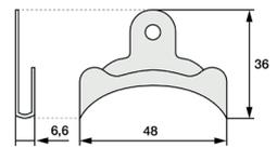
**Montageklammern Stahl verzinkt MK-05-M (ab 3 m Rutenlänge 6 St. im Lieferumfang enthalten)**
